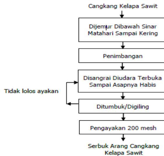
Gambar 2.8 Proses Pembuatan Serbuk Cangkang Kelapa Sawit
