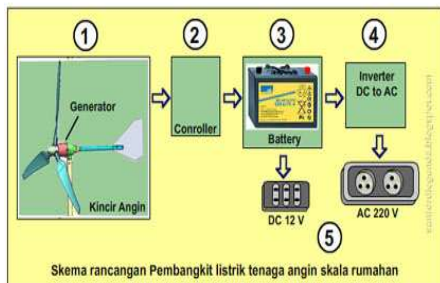
Gambar 2. 5 Skema Pembangkit Listrik Tenaga Angin
