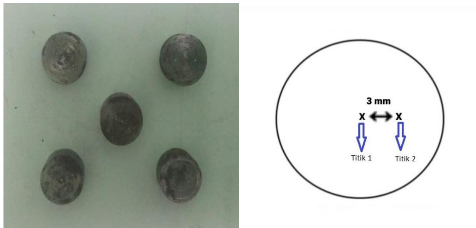
Gambar 4.12 spesimen pengujian hardnes rockwell sebelum proses annealing
