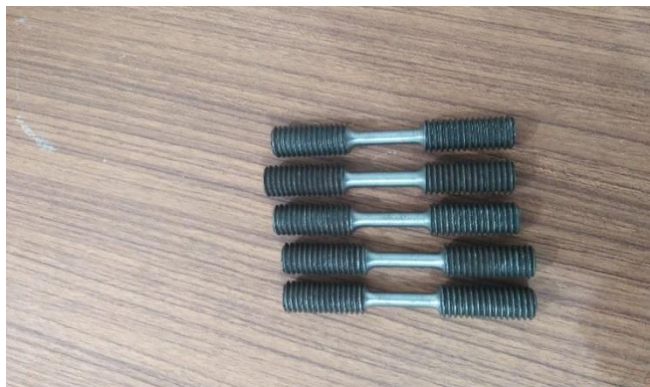
Gambar 3.2 spesimen baja st 37 setelah di bubut dan di ulir
