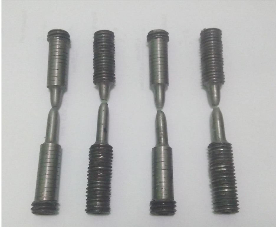
Gambar 4.1 spesimen pengujian tarik sebelum proses annealing
