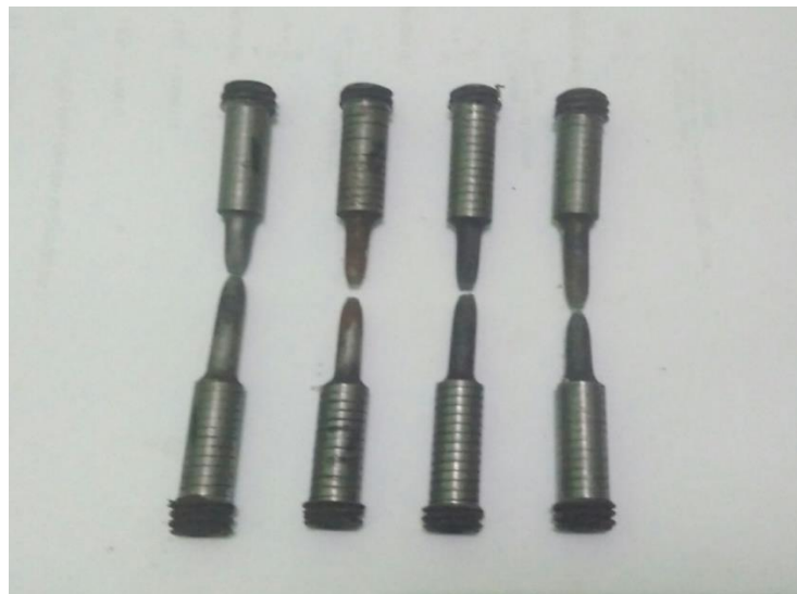
Gambar 4.6 spesimen uji tarik sesudah proses annealing
