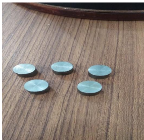
Gambar, 3.4 spesimen baja st 37 bahan pengujian hardness
