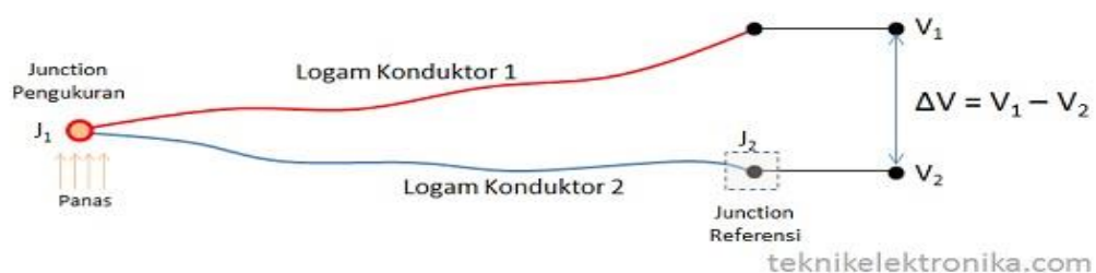
Gambar 2.4 Kontruksi Prinsip Kerja Termokopel
