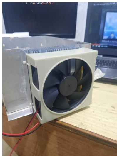
Gambar 2. Proses pemasangan Heatsink, Peltier, & Kipas
