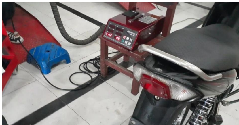
Gambar 4.11. Pengujian emisi gas buang dengan menggunakan Gas Analyzer
