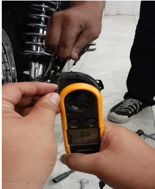
Gambar 4.10. Pengukuran kecepatan angin gas buang
