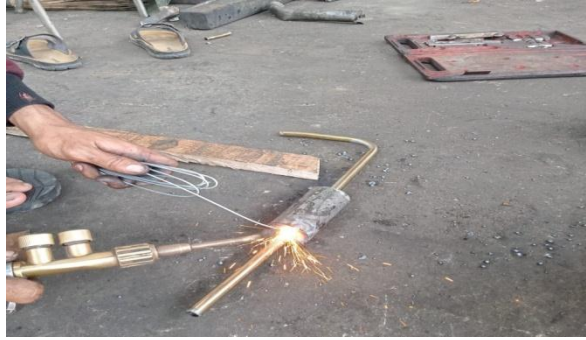
Gambar 4.16. Proses pengelasan tabung kondensor tahap 3
