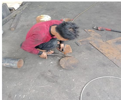
Gambar 4.5. Proses pengguntingan plat
