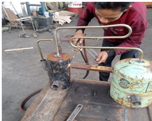
Gambar 4.18. Pengelasan penahan antara tabung
