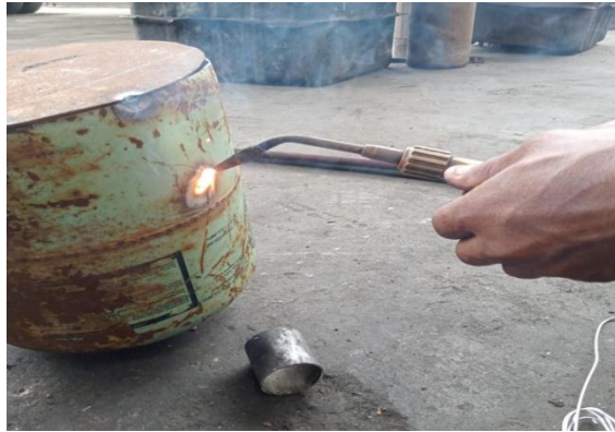
Gambar 4.8. Pembuatan lobang untuk memasukan plastik ke tabung reaktor
