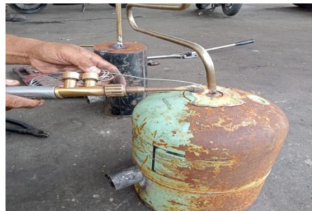
Gambar 4.12. Proses pengelasan selang penghubung antara tabung
