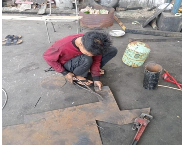
Gambar 4.6. pemotongan plat untuk tabung reaktor kecil
