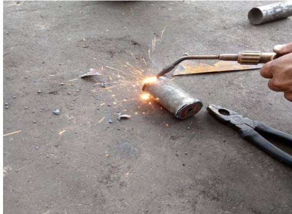
Gambar 4.14. Proses pengelasan tabung kondensor tahap 1
