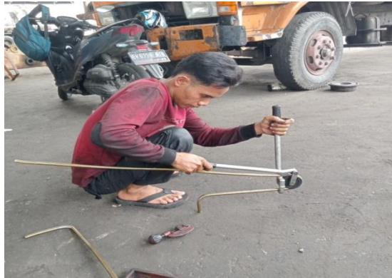
Gambar 4.11. Proses pembengkokan selang penghubung
