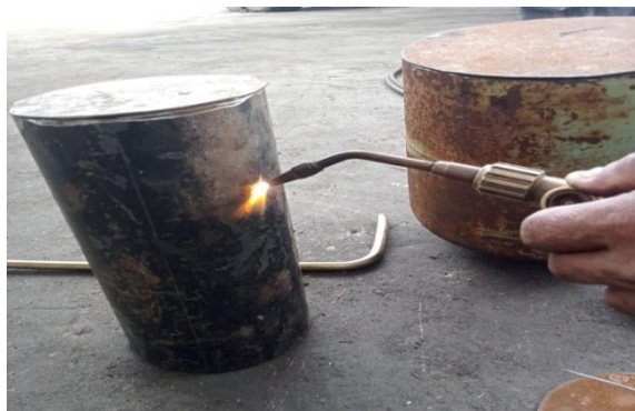
Gambar 4.9. Pembuatan lobang untuk tabung reaktor kecil
