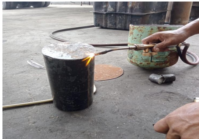
Gambar 4.7. Proses pengelasan tutup tabung reaktor kecil
