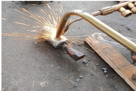
Gambar 4.17. Proses pengelasan tabung kondensor tahap 4
