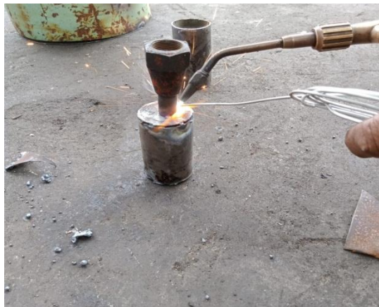
Gambar 4.15. Proses pengelasan tabung kondensor tahap 2
