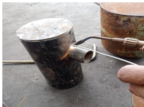
Gambar 4.10. Pengelasan untuk tutup tabung reaktor kecil
