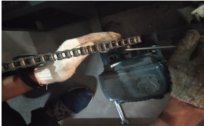
Gambar.3.28.Penguncian poros ou put dengan rantai penghubung.
