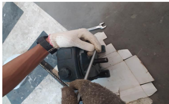
Gambar.3.24.Mengunci baut kepala out cover .
