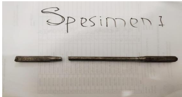
Gambar 4.2 Spesimen sesudah dilakukan pengujian puntir
