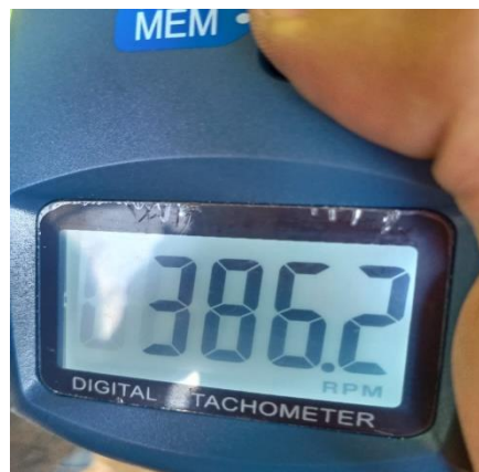
Gambar pengukuran pengukuran putaran turbin menggunakan alat ukur tachometer
