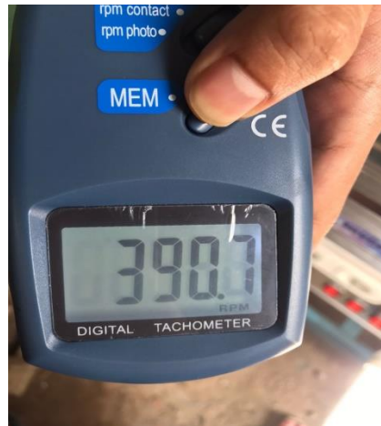
Gambar pengukuran putaran turbin menggunakan alat ukur tachometer
