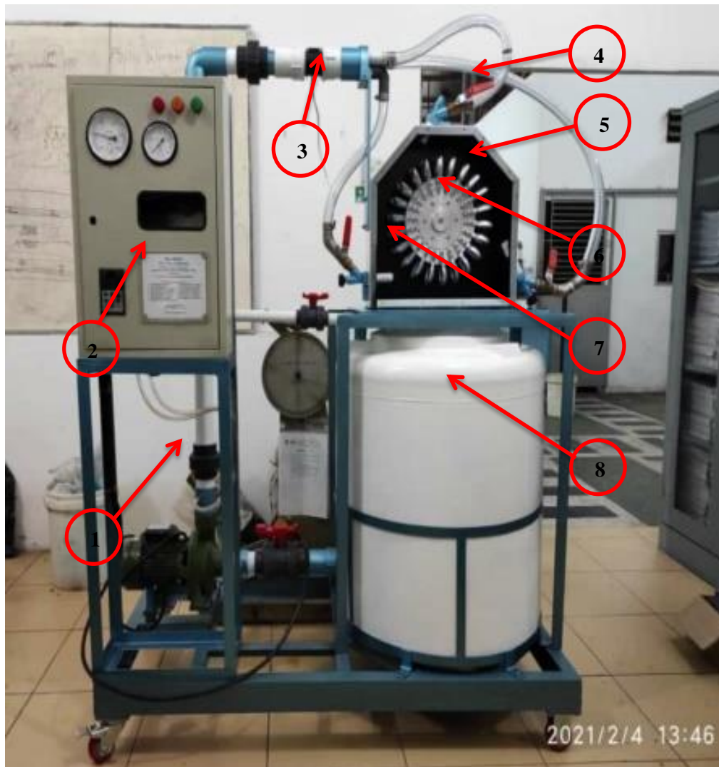
Gambar 3.9 Skema Pengujian Turbin Pelton
