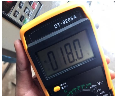
Gambar pengukuran tegangan menggunakan alat ukur multimeter
