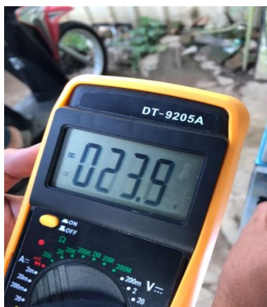
Gambar pengukuran tegangan menggunakan alat ukur multimeter
