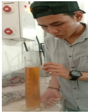
Gambar 3.11 Penuangan Minyak Pelumas Kedalam Tabung
