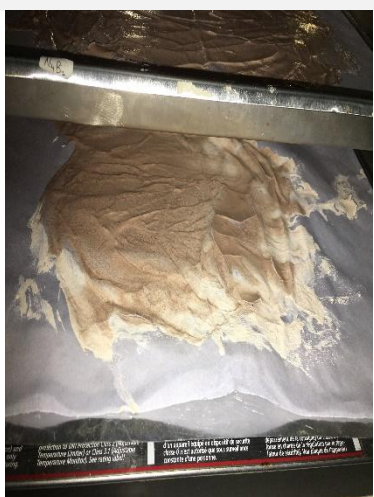
Gambar 22. Pati Hasil Endapan Dikeringkan Dengan Oven
