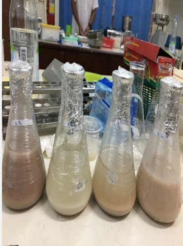
Gambar 24. Pencampuran Antara Tepung Sorgum 25gr, Air mendidih 75ml dan HCl Sesuai Dengan Konsentrasi
