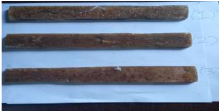
Gambar 4.27 Spesimen uji Three Point Bending
