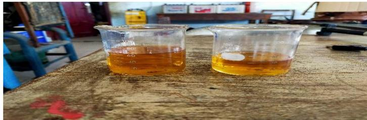
Gambar langkah percobaan 6. minyak hasil pirolisis.
