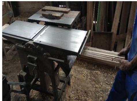
Gambar 3.27 Proses pengetaman papan bambu laminasi
