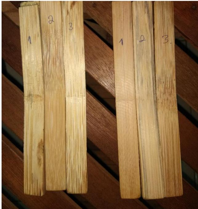
Gambar 4.1 Spesimen uji *Three Point Bending*
