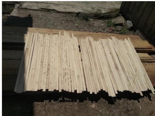
Gambar 3.20 Proses pengeringan bambu
