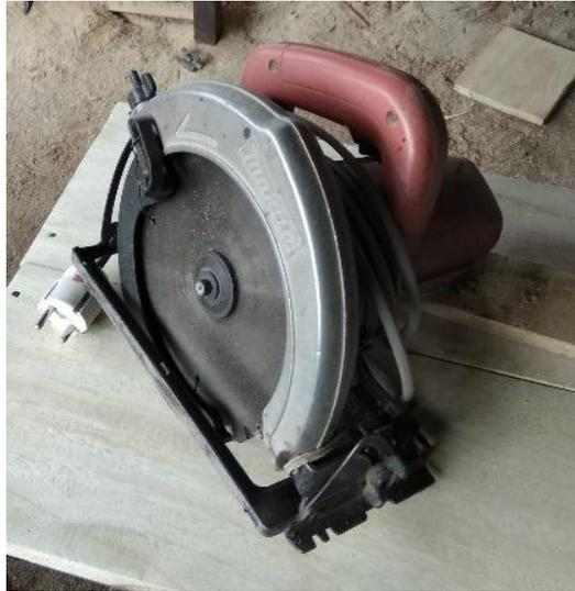
Gambar 3.9 Mesin Groove Cutte
