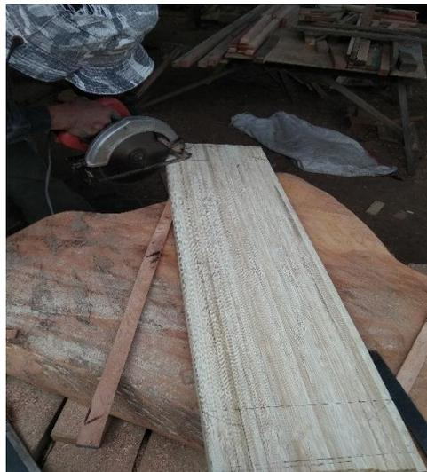
Gambar 3.29 Proses pemotongan papan bambu laminasi
