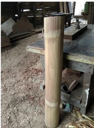
Gambar 3.17 Bambu setelah dipotong menjadi panjang 110cm
