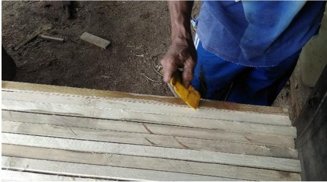
Gambar 3.24 Proses meratakan lem menggunakan scrap dempul
