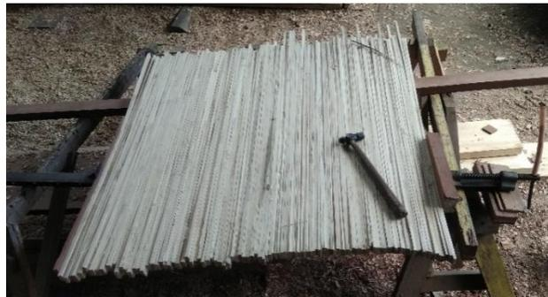
Gambar 3.22 Proses penyusunan bilah-bilah bambu
