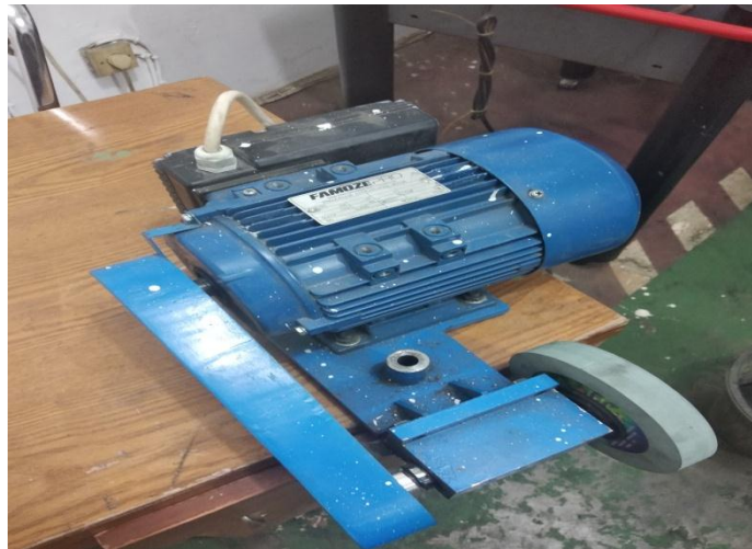
Gambar 3.3 Mesin Gerinda Yang Sudah Dioptimalisasi
