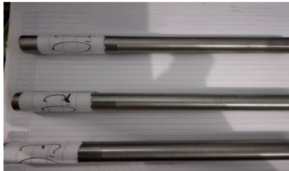
Gambar 4.18 Hasil Spesimen Yang Diuji Dengan Kecepatan 440 Rpm
