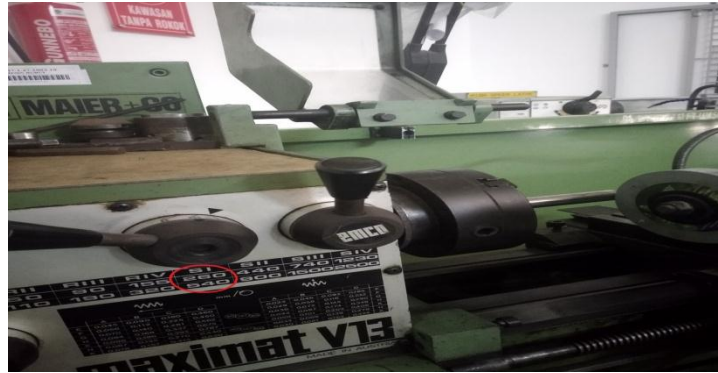
Gambar 4.14 Pengujian Dengan Kecepatan 260 Rpm
