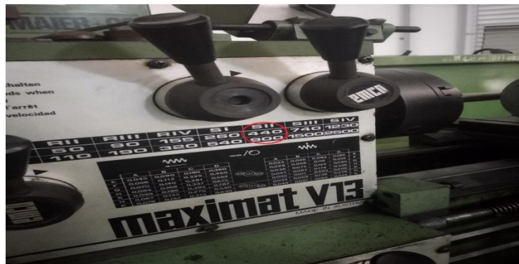
Gambar 4.15 Pengujian Dengan Kecepatan 440 Rpm
