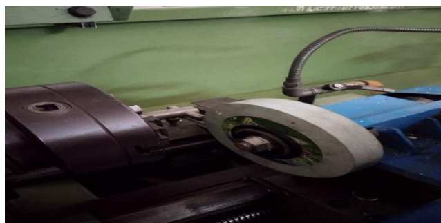
Gambar 4.16 Melakukan Pengasahan Dengan Dresser
