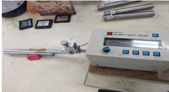
Gambar 4.20 Pengujian Material Stainless Steel Type 304 Dengan Menggunakan Roughnes Tester
