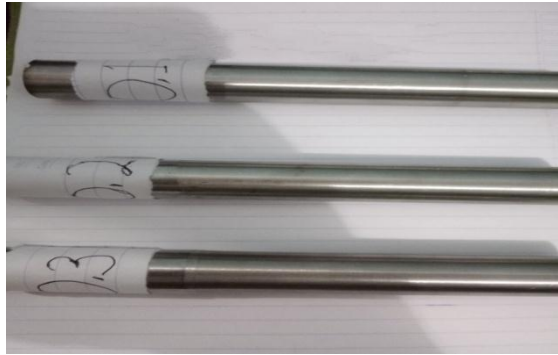
Gambar 4.17 Hasil Spesimen Yang Diuji Dengan Kecepatan 260 Rpm
