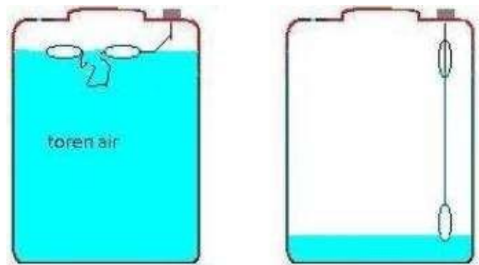
Gambar 2.9 WLC tipe float dengan pelampung bertali (Tadeus & Setiono, 2019a)
