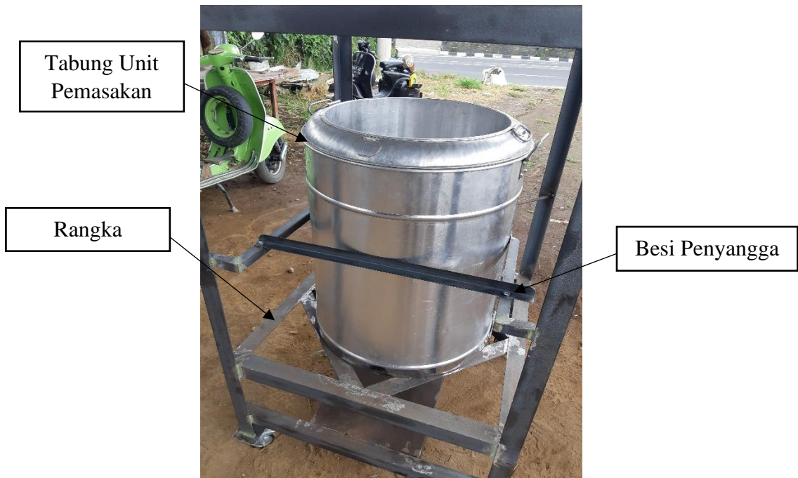
Gambar 4. 11. Menyatukan Rangka dan Tabung Unit Pemasakan
