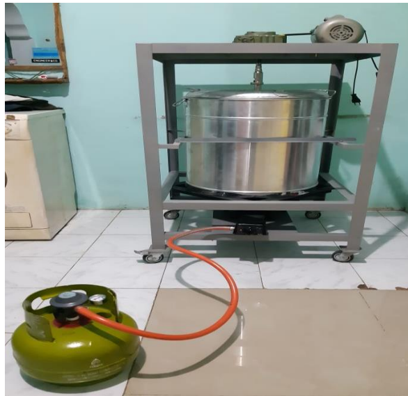
Gambar 4. 31. Mesin Pengaduk Selai Srikaya Yang Telah Berhasil Dibuat
