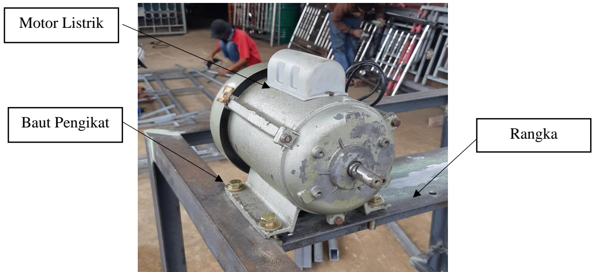
Gambar 4. 12. Memasang Motor Listrik
