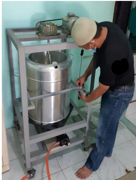
Gambar 4. 24. Menyatukan tabung unit pemasakan ke rangka mesin
