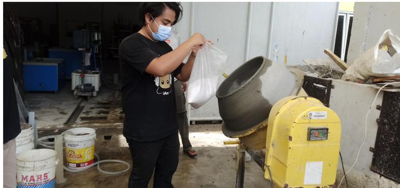
Gambar 3.2 Pembuatan benda uji
