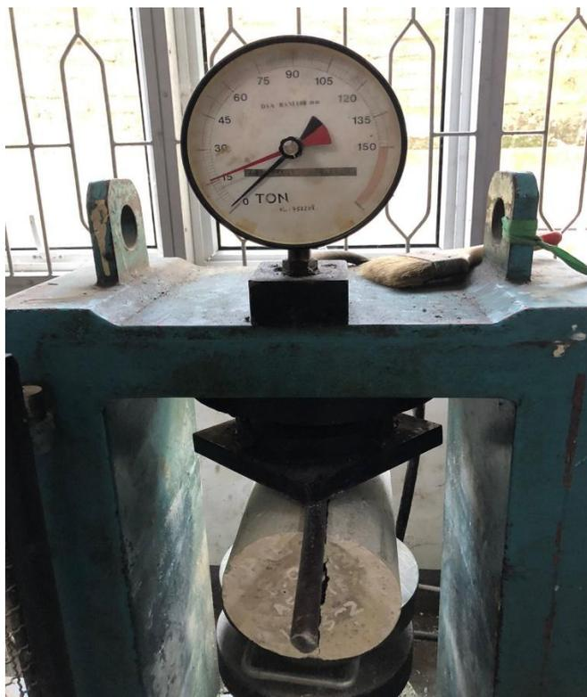
Gambar L. 9 Pengujian kuat tarik beton
