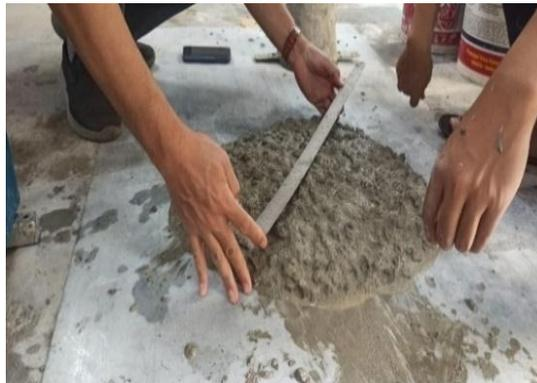
Gambar 3.3. Pengujian *slump flow*
