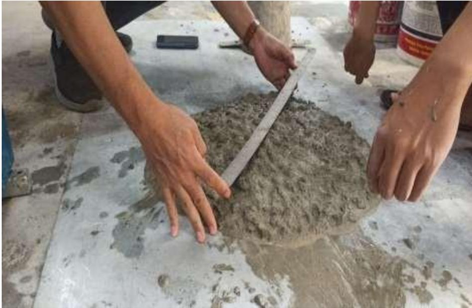
Gambar L.3: Melakukan *Slump Flow Test* pada Beton Segar
