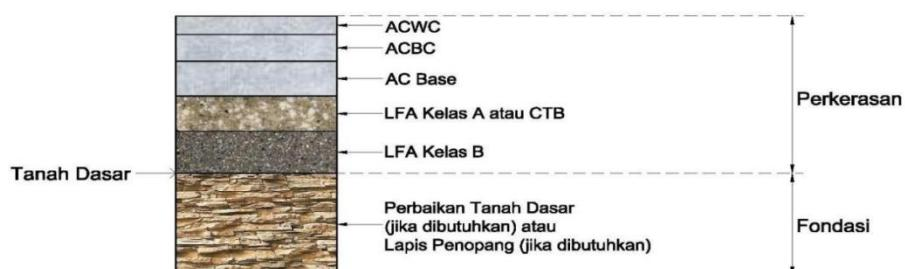
Gambar 2.2: Struktur Perkerasan Lentur (Kementerian Pekerjaan Umum dan Perumahan Rakyat; Direktorat Jenderal Bina Marga, 2017)
