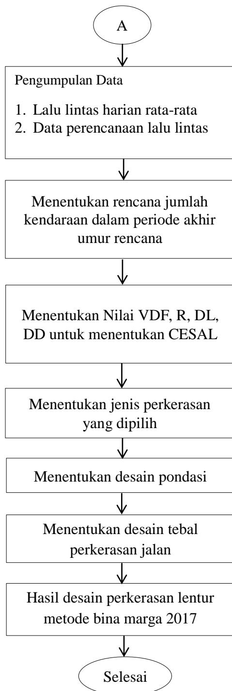
Gambar 3.2: Diagram Alir Perancangan Tebal Perkerasan Metode Bina Marga 2017
