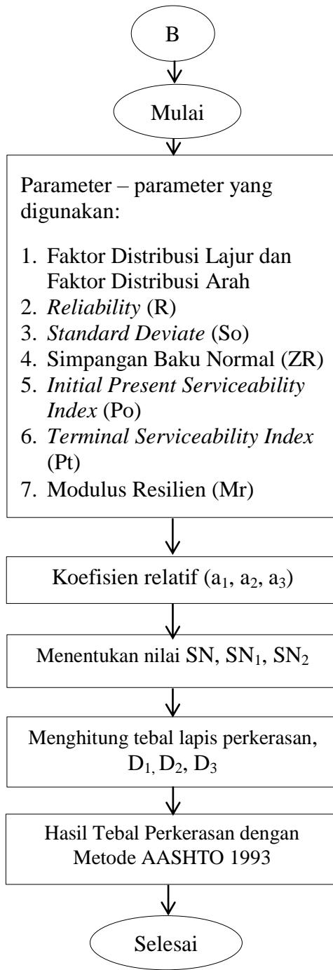
Gambar 3.3: Diagram Alir Perancangan Tebal Perkerasan Metode AASHTO 1993
