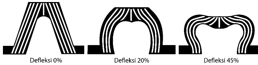
Gambar 2.7: Defleksi fender karena benturan kapal (Triatmodjo, 2009).
