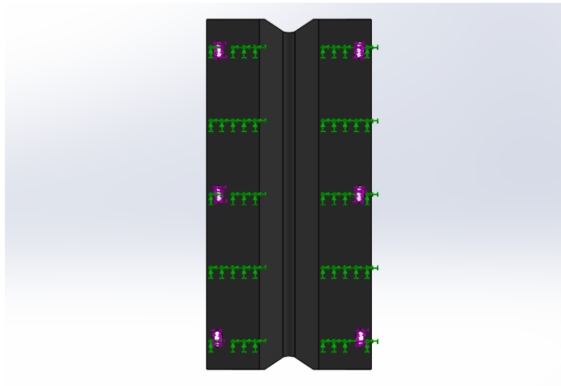
Gambar 3.9: Penerapan tumpuan jepit/ fixed geometry pada model V Fender 400H × 1500L.
