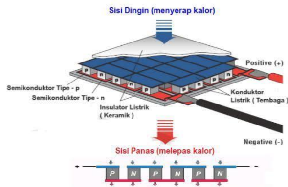
Gambar 2.6 Elemen peltier dua tipe semikonduktor
