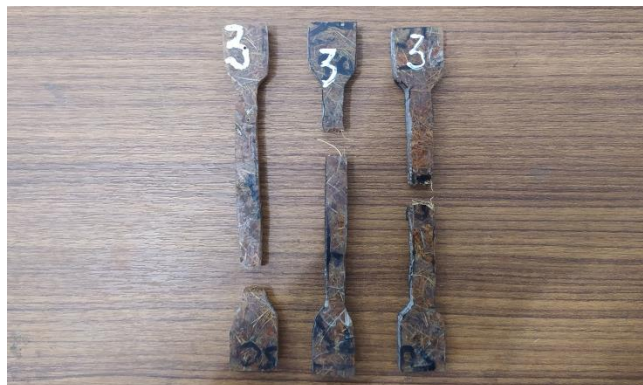
Gambar 4.18 Hasil Pengujian Tarik 25% Resin dan 75% Serat Sabut Kelapa
