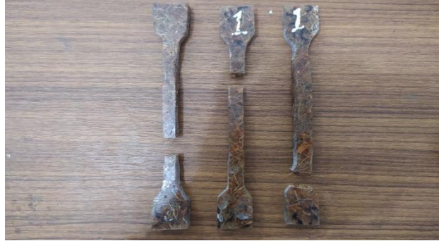
Gambar 4.16 Hasil Pengujian Tarik 70% Resin dan 30% Serat Sabut Kelapa
