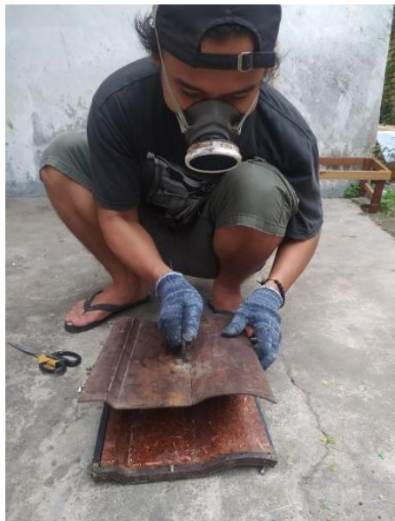
Gambar 4.12 Pelepasan Tutup Cetakan Atap.
