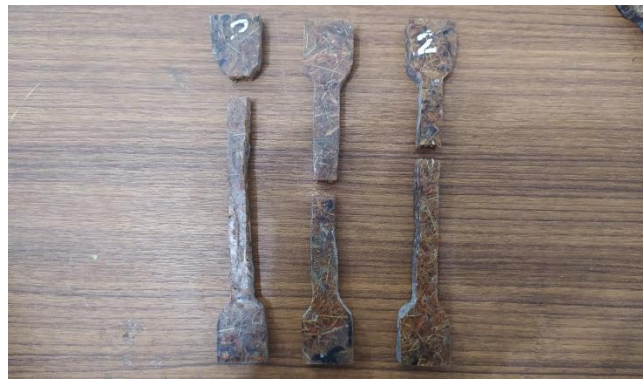
Gambar 4.17 Hasil Pengujian Tarik 50% Resin dan 50% Sabut Serat Kelapa
