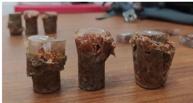
Gambar 4.24 Hasil Pengujian Tekan 80% Resin : 20% Serat Sabut Kelapa
