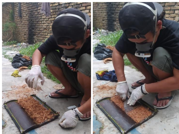
Gambar 4.10 (a)Penuangan resin (b)Penekanan serat.
