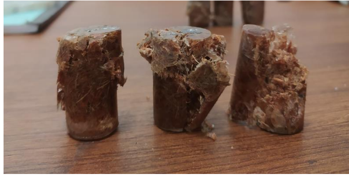
Gambar 4.23 Hasil Pengujian Tekan 90% Resin : 10% Serat Sabut Kelapa
