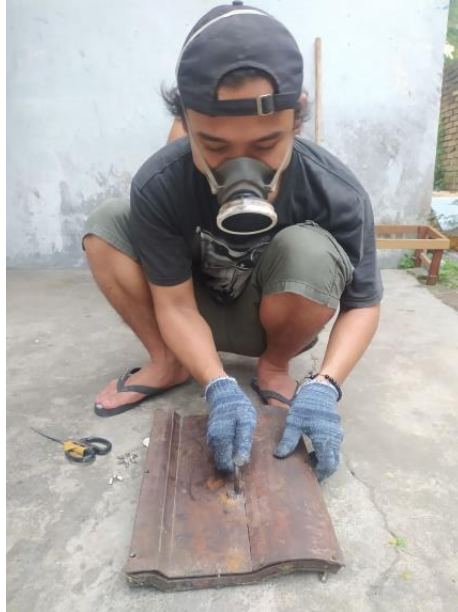
Gambar 4.11 Proses Penutupan Cetakan Atap.
