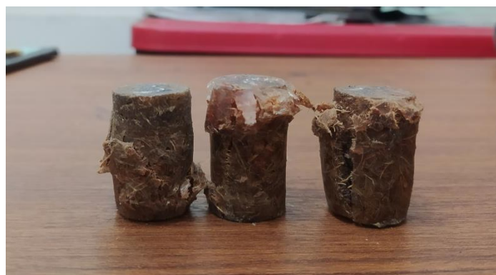
Gambar 4.25 Hasil Pengujian Tekan 70% Resin : 30% Serat Sabut Kelapa
