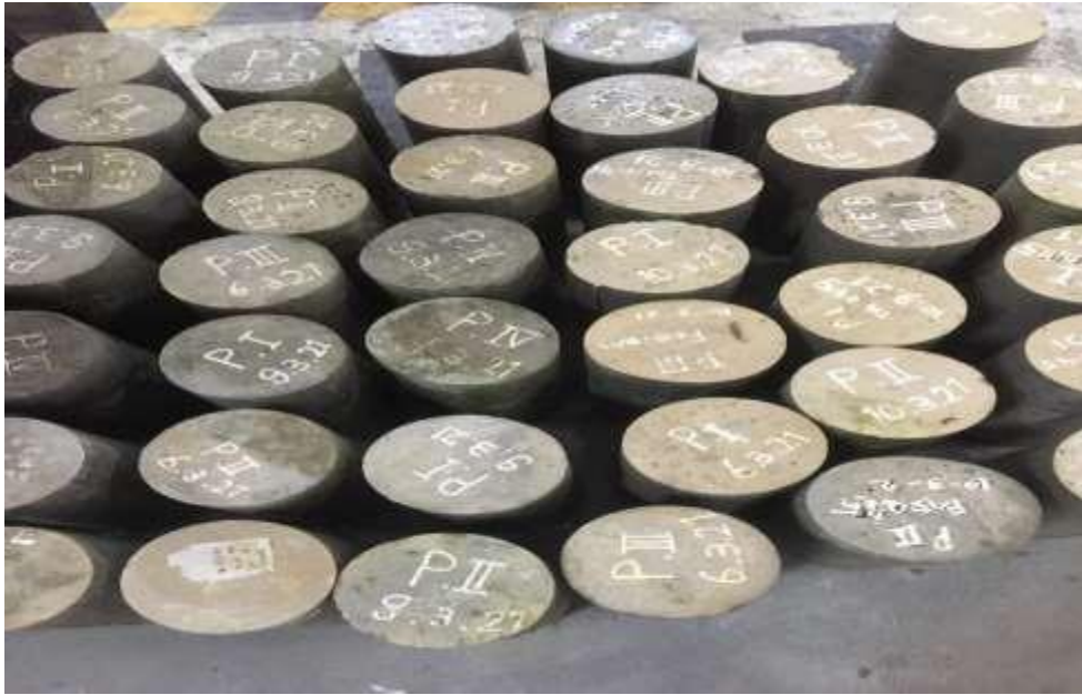
Gambar L.7: Mengeluarkan Beton yang Sudah Direndam Selama 28 Hari
