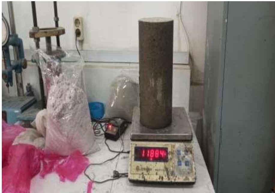
Gambar L.5: Menimbang Benda Uji Sebelum Perendam
