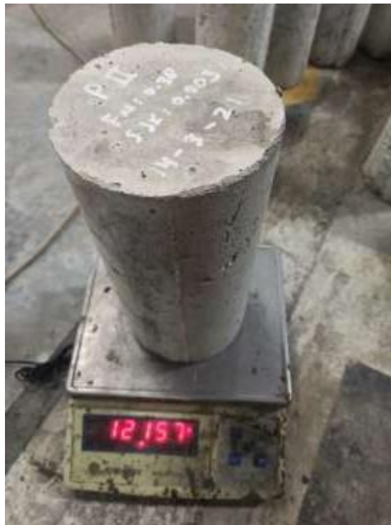
Gambar L.8: Menimbang Berat Beton Setelah Perendaman
