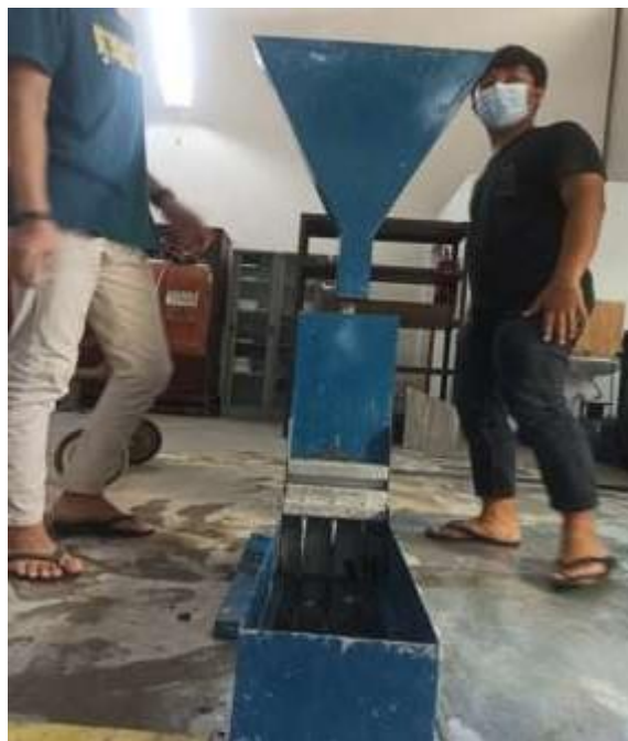
Gambar L. 2 Melakukan Pengujian V Funnel Test dan L – Box Test pada Beton Segar
