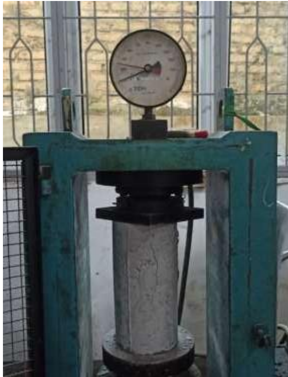
Gambar L. 9 Pengujian Modulus Elastisitas Beton
