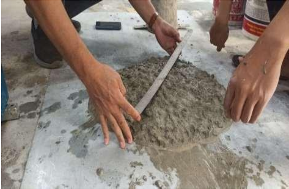
Gambar L.3: Melakukan Slump Flow Test pada Beton Segar
