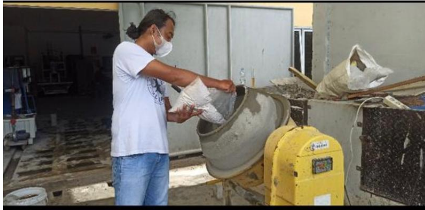
Gambar L.1: Mencampurkan Semua Bahan ke Dalam Mixer
