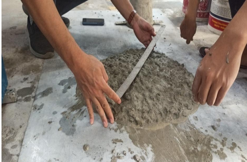
Gambar L.3: Melakukan Slump Flow Test pada Beton Segar
