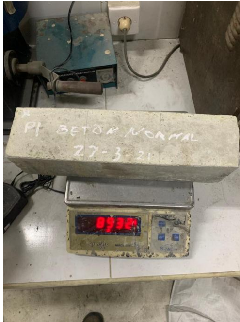
Gambar L.7: Menimbang Berat Beton Setelah Perendaman
