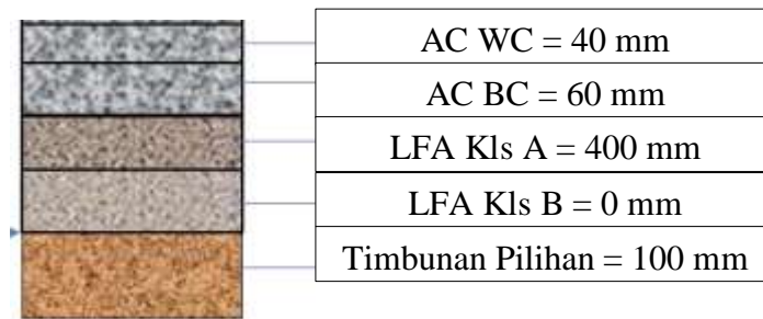
Gambar 4.2: Detail Perkerasan Metode Bina Marga 2017
