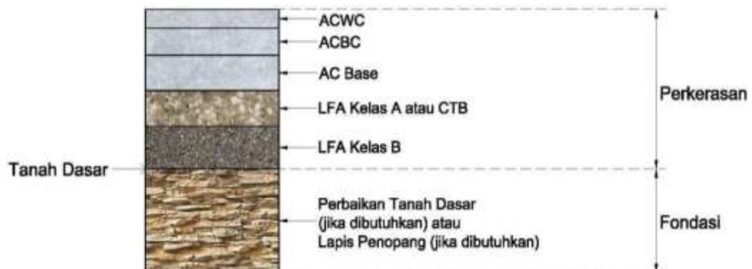
Gambar 2.2: Struktur Perkerasan Lentur (Kementerian Pekerjaan Umum dan Perumahan Rakyat; Direktorat Jenderal Bina Marga, 2017)
