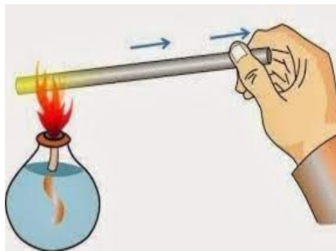
Gambar 2.1 Laju Perpindahan Panas Konduksi (Kosim Abdurohman, 2014)
