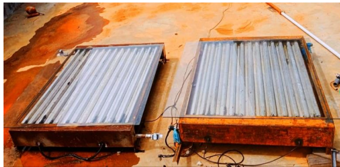
Gambar 4.1 Rancangan alat solar water heater dengan variasi ukuran honeycomb 20mm dan 30mm
