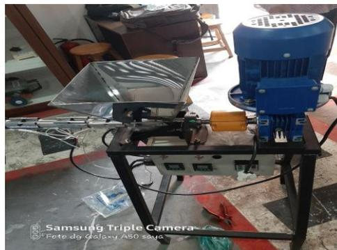
Gambar 2.4 Mesin ekstruksi ulir *Screw extruder*
