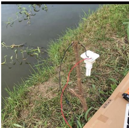
Gambar 4.7 Kondisi Sensor Ldr Dalam Keadaan Terang
