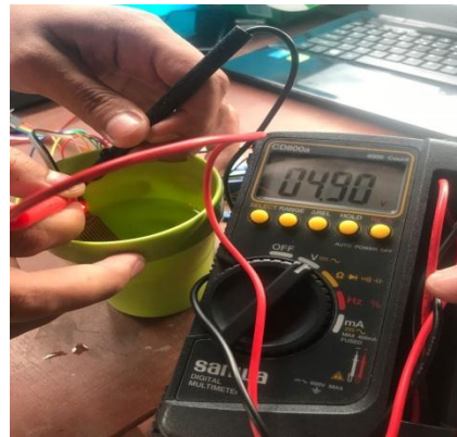
Gambar 4.10 Kondisi Sensor Water Level Dalam Keadaan Terkena Air
