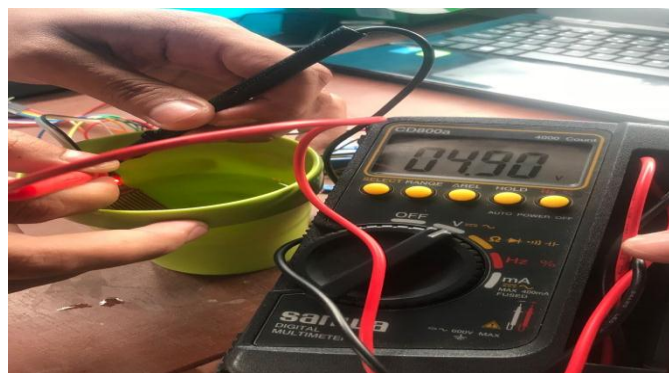
Gambar 4.4 Pengukuran hasil Output Sensor Water Level Setelah Air Mencapai batas Maksimal Pada Sensor
