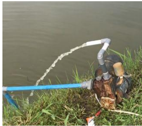
Gambar 4.9 Kondisi Sensor Water Level Dalam Keadaan Belum Terkena Air
