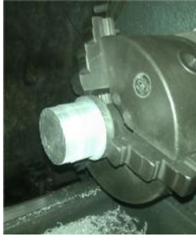
Gambar 4.5 Proses pembubutan puli
