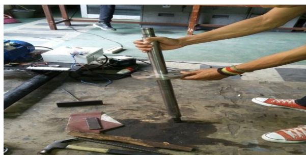
Gambar 3.20. Pemasangan flange dan cakram
