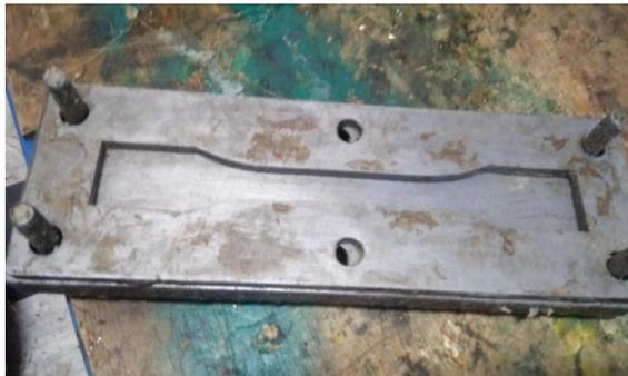
Gambar 3.7. Cetakan Spesimen
