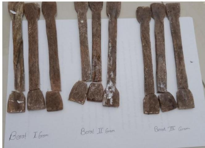
Gambar 4.9. Hasil Spesimen Komposit yang Telah diuji Tarik
