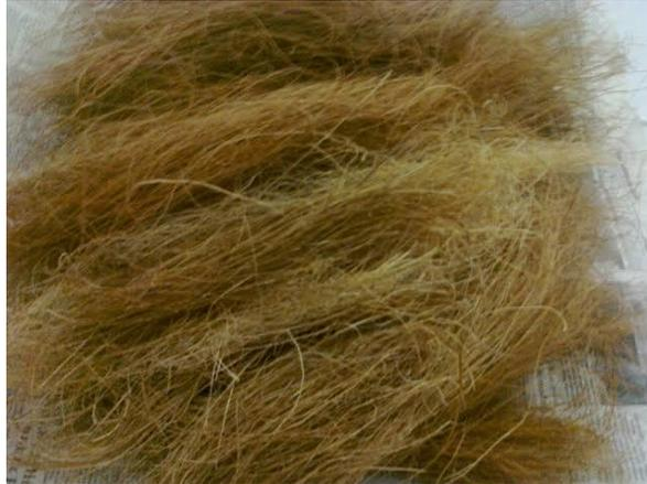
Gambar 3.1. Serat Sabut Kelapa yang dipakai dalam Pembuatan Helm dan Spesimen
