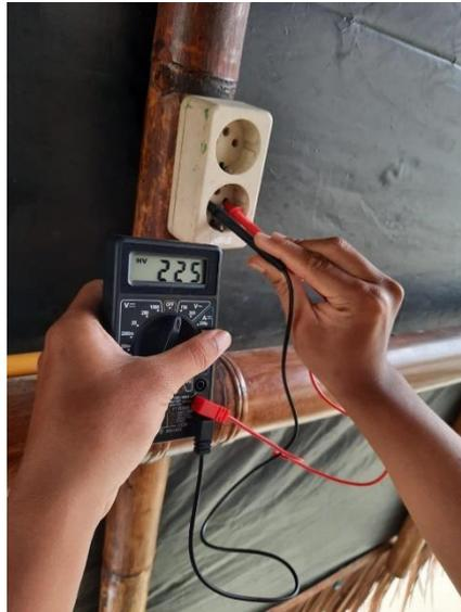
Proses pengukuran tegangan.
