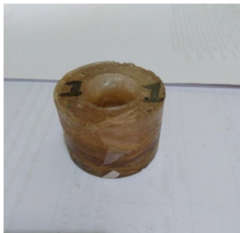
Gambar 4.2 Hasil Pengujian Spesimen Uji Tekan 97% Resin : 3% Serat
