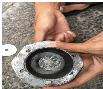
Gambar 3.9 cetakan roda tertutup
