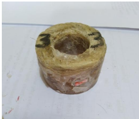
Gambar 4.4 Hasil Pengujian Spesimen Uji Tekan 95% Resin : 5% Serat
