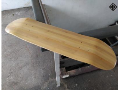
Gambar 2.4 Skateboard menggunakan material Bambu(Dedeh kurniasih,2013)
