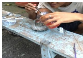
Gambar 4.12 penuangan resin kedalam cetakan
