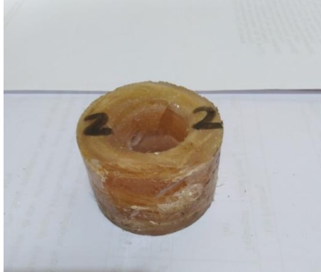
Gambar 4.3 Hasil Pengujian Spesimen Uji Tekan 96% Resin : 4% Serat
