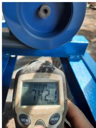
Gambar 3.45. Pengukuran Rpm pada *Pulley Input Gearbox*
