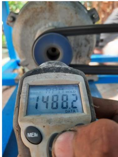
Gambar 3.44. Pengukuran Rpm Motor Listrik
