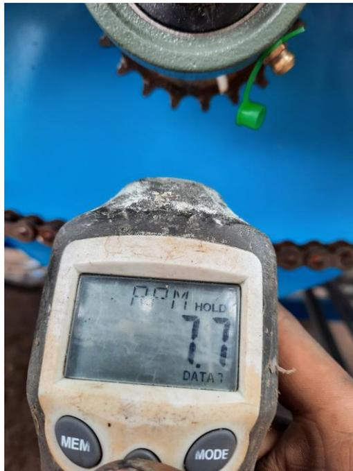
Gambar 3.47. Pengukuran Rpm pada putaran *grader sortir*.
