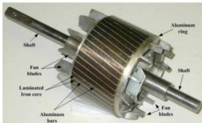
Gambar 2.25. konstruksi rotor sangkar motor induksi (Cendana, 2018)
