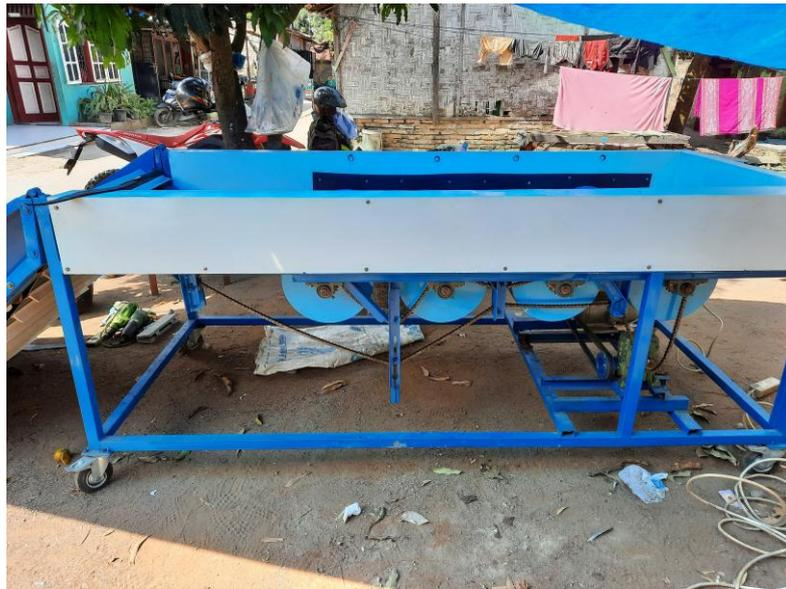
Gambar 3.42. Sistem Transmisi Mesin Sortir Jeruk
