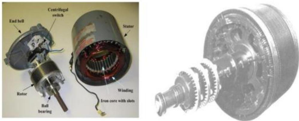
Gambar 2.24. Rotor dan Stator Motor Induksi (Cendana, 2018)
