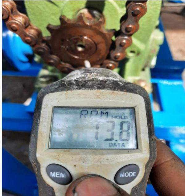
Gambar 3.46. Pengukuran Rpm Pada *sprocket Output Gearbox*
