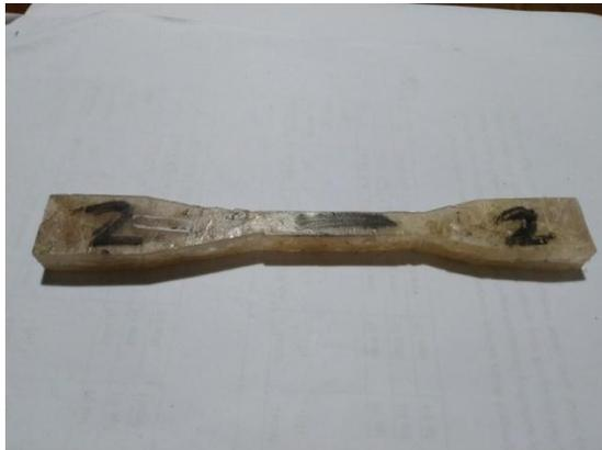
Gambar 3.22 Spesimen Uji Tarik 75% Resin :25 % Serat
