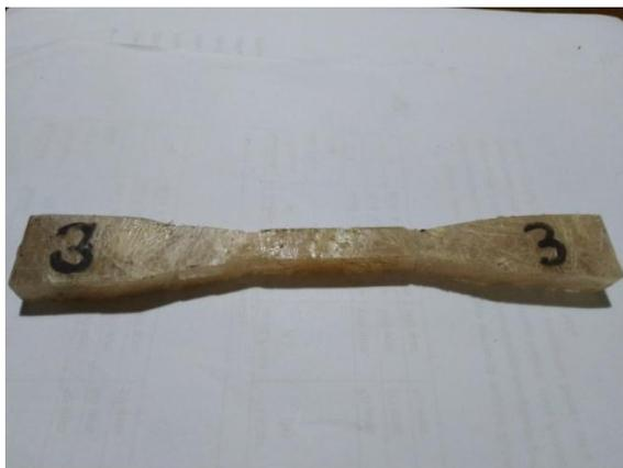
Gambar 3.23 Spesimen Uji Tarik 50% Resin : 50% Serat
