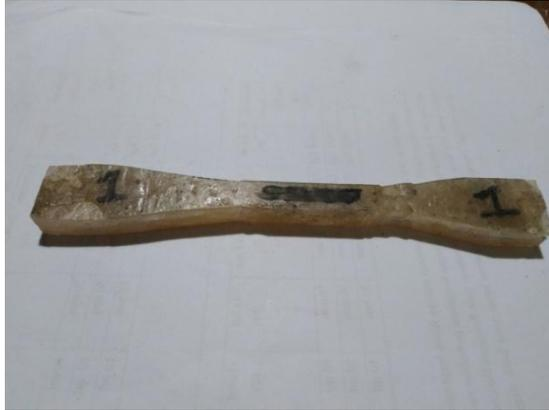
Gambar 3.21 Spesimen Uji Tarik 70% Resin : 30 % Serat
