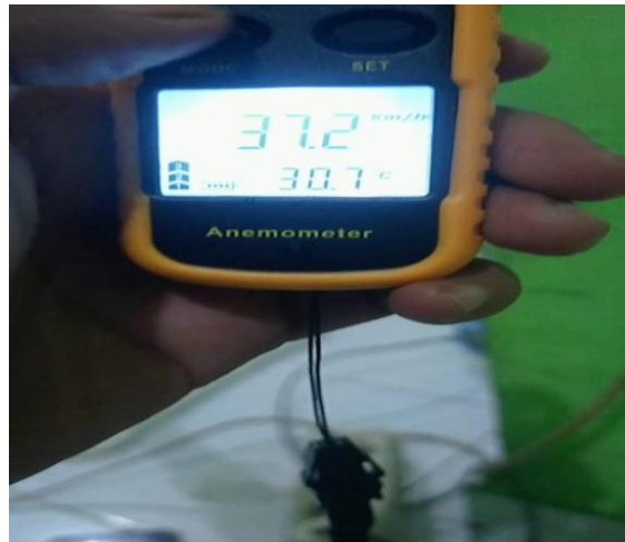
Gambar 4.11 kecepatan angin untuk memutar turbin
