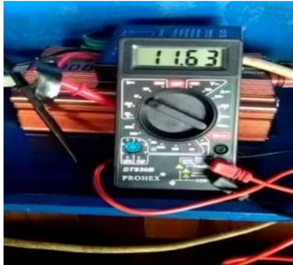
Gambar 4.10 tegangan yang dihasilkan turbin angin
