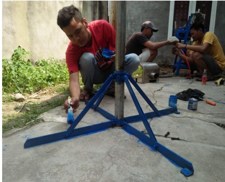
Gambar 4.9 membersihkan peralatan dan pengecatan alat.
