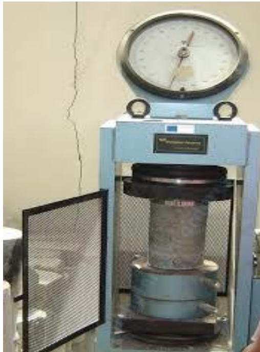
Gambar 4.7: Kuat tekan pada benda uji.
