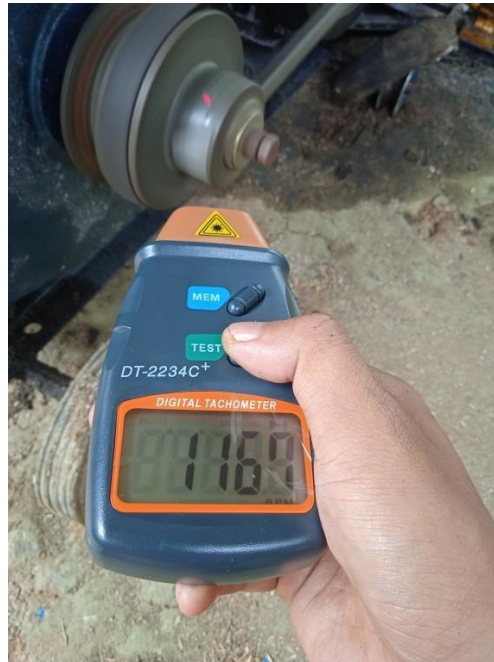
Gambar 4.18 Hasil pengukuran kecepatan pada Rated Power mesin diesel dengan menggunakan bahan bakar biodiesel B-100
