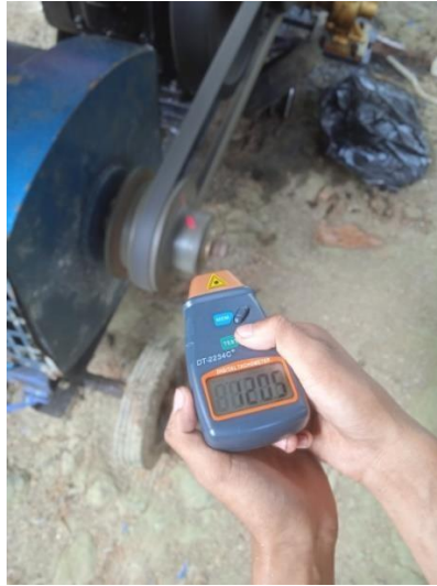
Gambar 4.14 Hasil pengukuran kecepatan pada Rated Power mesin diesel dengan menggunakan bahan bakar biodiesel B-40
