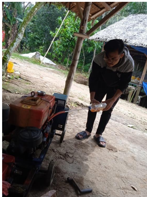
Gambar 4.21 Proses percobaan bahan bakar Biodiesel B-100
