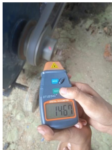
Gambar 4.15 Hasil pengukuran kecepatan pada Max Power mesin diesel dengan menggunakan bahan bakar biodiesel B-40
