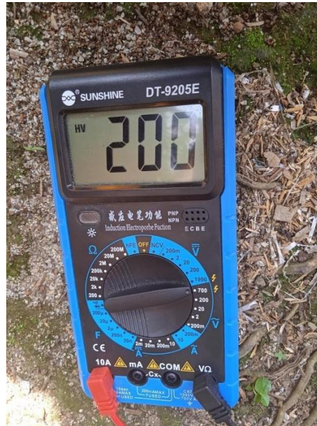
Gambar 4.16 Hasil pengukuran tegangan pada Max Power mesin diesel dengan menggunakan bahan bakar biodiesel B-40
