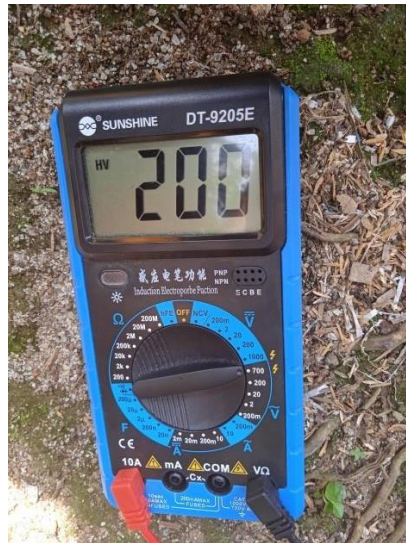
Gambar 4.20 Hasil pengukuran tegangan pada Max Power mesin diesel dengan menggunakan bahan bakar biodiesel B-100
