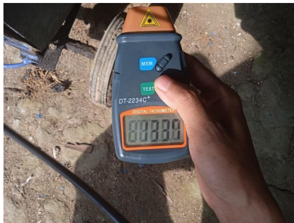
Gambar 4.12 Hasil pengukuran kecepatan pada Rated Power mesin diesel dengan menggunakan bahan bakar biodiesel B-20
