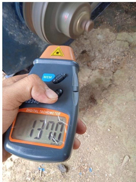
Gambar 4.19 Hasil pengukuran kecepatan pada Max Power mesin diesel dengan menggunakan bahan bakar biodiesel B-100
