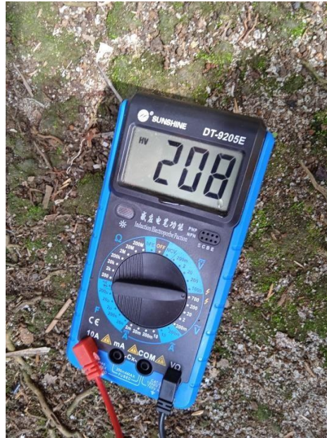
Gambar 4.11 Hasil Pengukuran tegangan pada kecepatan mesin pada keadaan Max Power menggunakan biodiesel B-20
