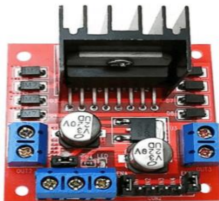
Gambar 2.13 IC L298 & Modul Driver Motor L298N Sumber: Dedi Setiawan dkk (2020)
