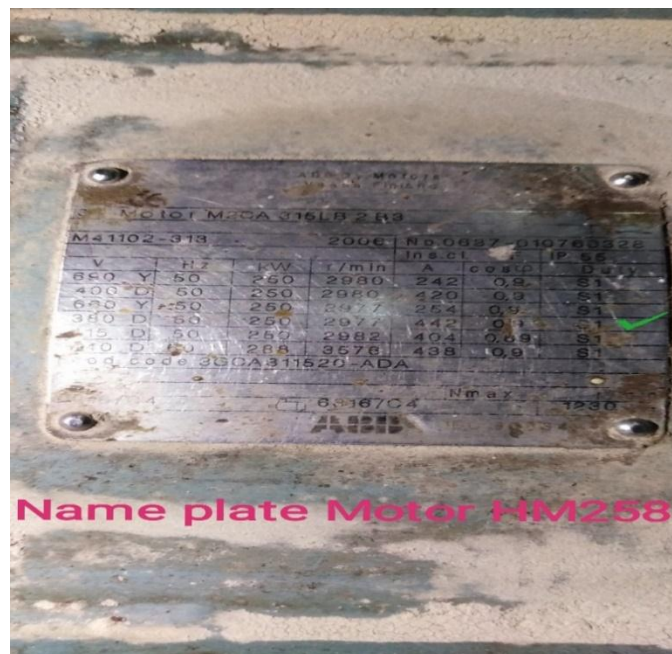
Gambar 3.2 Nameplate Dari Motor Berdaya 250 kW Penggerak Mesin
