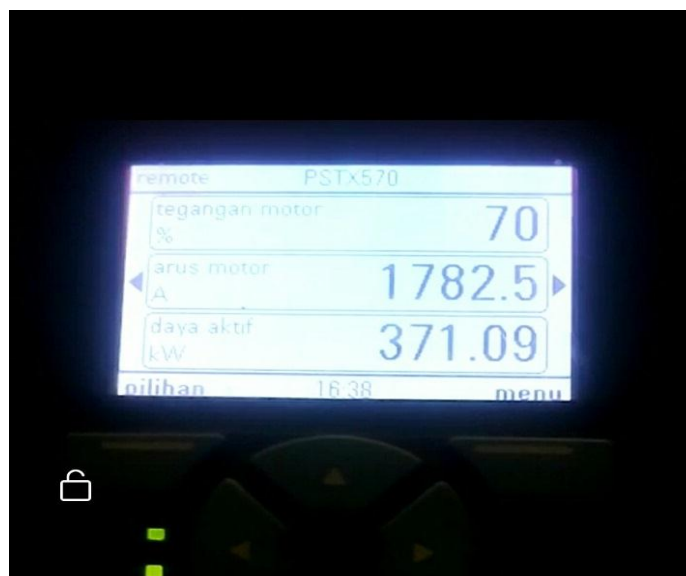
Gambar 4.4 Puncak Arus Start Yang Terlihat Pada Module Display&Key
