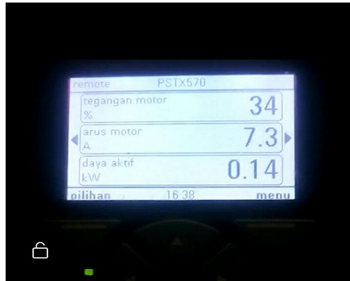
Gambar 4.3 Display Data Besaran Arus Pada Saat Proses Start Berlangsung
