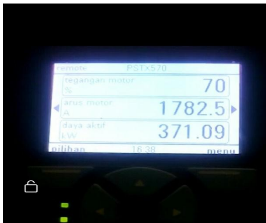
Gambar 4.4 Puncak Arus Start Yang Terlihat Pada Module Display&Key
