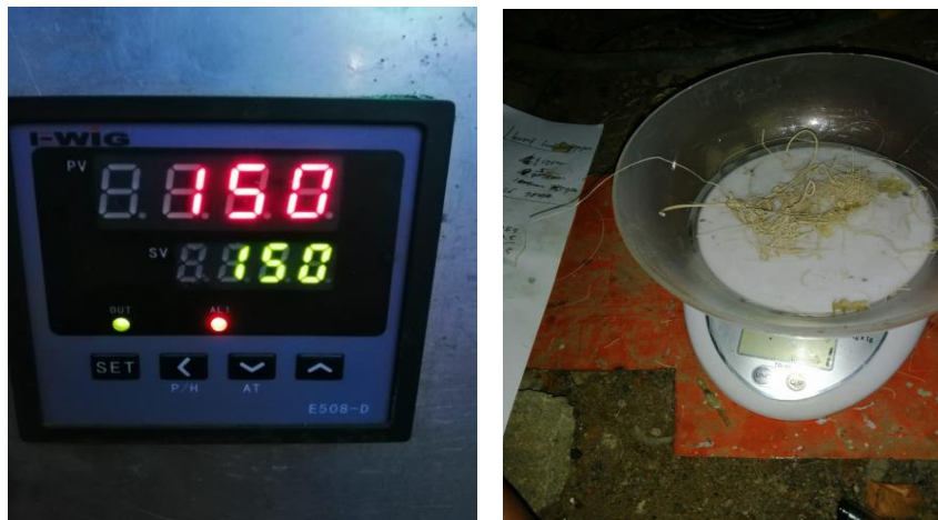
Gambar 4.1 Hasil penelitian dari temperatur 150 °C dan berat hasil extrusion
