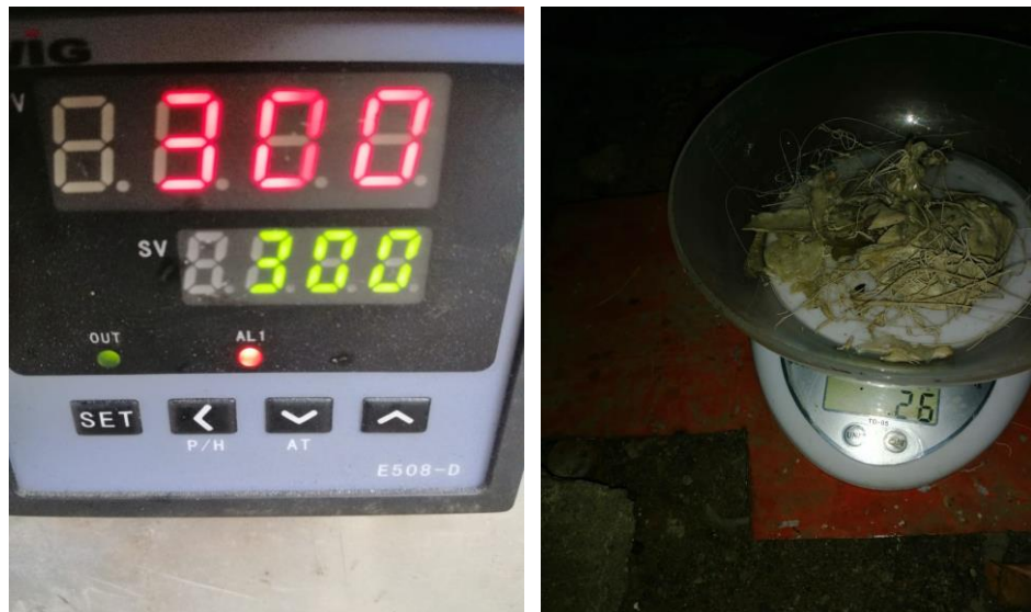
Gambar 4.4 Hasil penelitian dari temperatur 300 °C dan berat hasil extrusion
