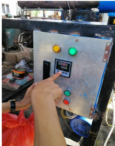
Gambar 3.15 Mengatur Suhu Pada Mesin Exstruder
