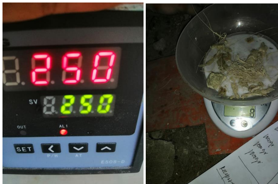
Gambar 4.3 Hasil penelitian dari temperatur 250 °C dan berat hasil extrusion
