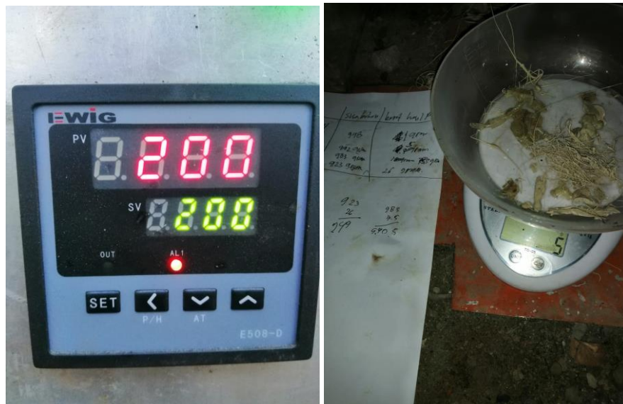
Gambar 4.2 Hasil penelitian dari temperatur 200 °C dan berat hasil extrusion
