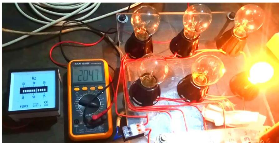
Gambar 4.18 Tegangan keluaran dan Frekuensi Generator pada Beban Lampu Pijar 5 watt
