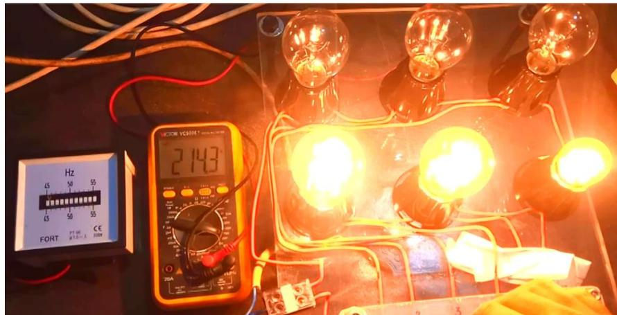
Gambar 4.23 Tegangan keluaran dan Frekuensi Generator pada Beban Lampu Pijar 5 watt, 15 watt, 25 watt (45 watt)
