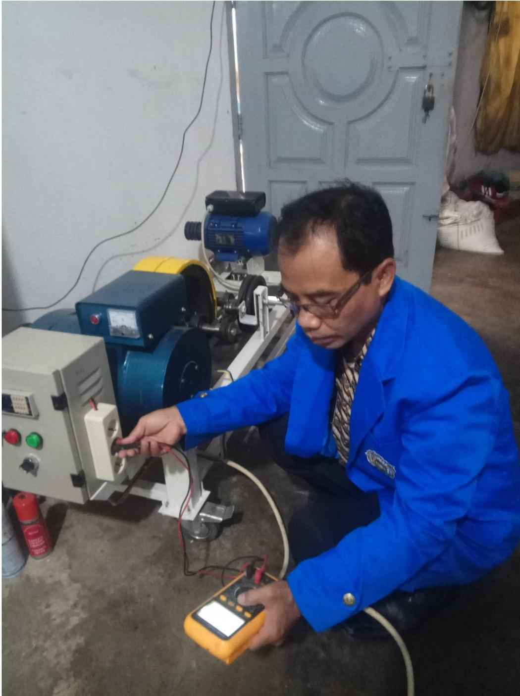
**Gambar. Pengukuran Keluaran Dari Generator**
