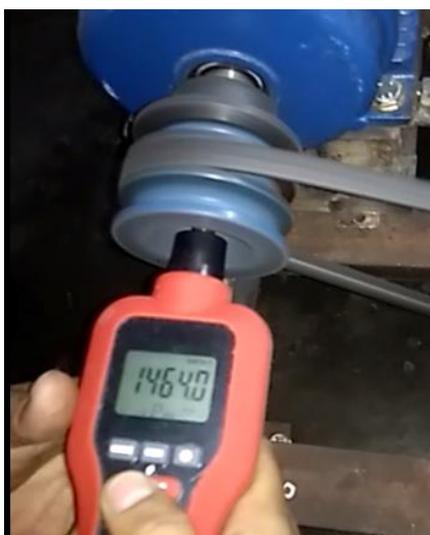
Gambar 4.8 Rpm pada penggerak awal (Motor Induksi)
