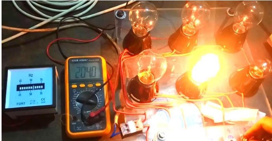
Gambar 4.19 Tegangan keluaran dan Frekuensi Generator pada Beban Lampu Pijar 15 watt
