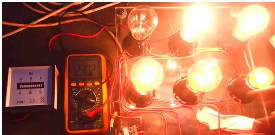
Gambar 4.27 Tegangan keluaran dan Frekuensi Generator pada Beban Lampu
