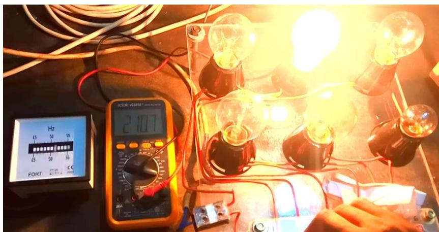
Gambar 4.24 Tegangan keluaran dan Frekuensi Generator pada Beban Lampu Pijar 60 watt
