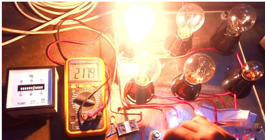
Gambar 4.26 Tegangan keluaran dan Frekuensi Generator pada Beban Lampu
