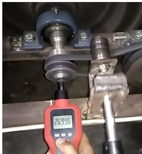
Gambar 4.10 Rpm pada Transmisi 2 (*Flywheel*)
