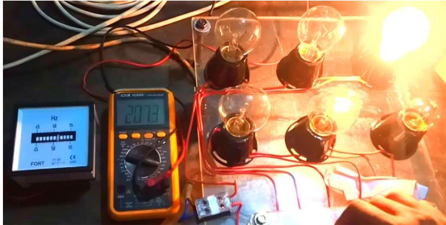
Gambar 4.22 Tegangan keluaran dan Frekuensi Generator pada Beban Lampu Pijar 40 watt
