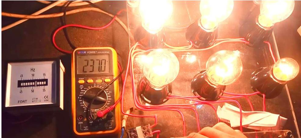
Gambar 4.28 Tegangan keluaran dan Frekuensi Generator pada Beban Lampu Pijar 5 watt, 15 watt, 25 watt, 40 watt, 60 watt dan 100 watt (245 watt)
