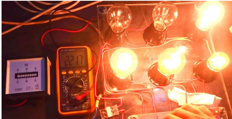
Gambar 4.25 Tegangan keluaran dan Frekuensi Generator pada Beban Lampu
