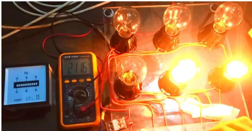
Gambar 4.20 Tegangan keluaran dan Frekuensi Generator pada Beban Lampu Pijar 5 watt dan 15 watt (20Watt)
