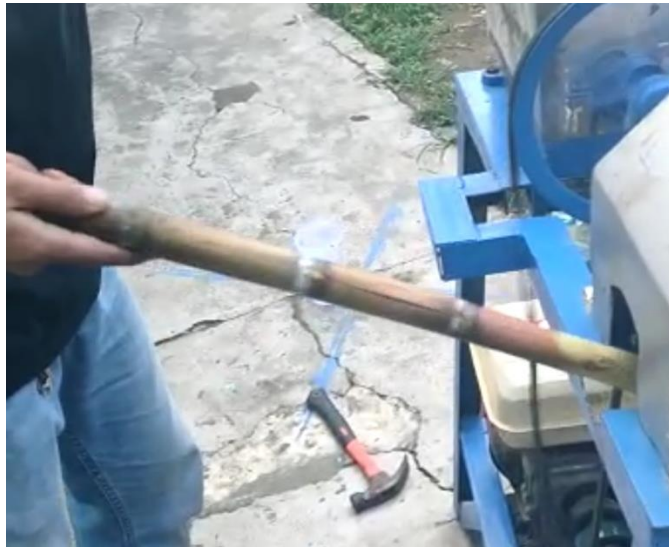
Gambar 4,27 Proses Pembersihan Kulit Tebu
