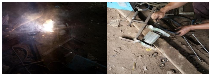
Gambar 4.10 (a) Pengelasan Dudukan Roll (b) Hasil Penambahan Dudukan Roll Peras
