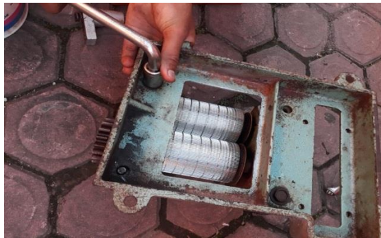
Gambar 4.14 Hasil Pemasangan Dudukan Mesin Peras Dan Dudukan Roll Peras
