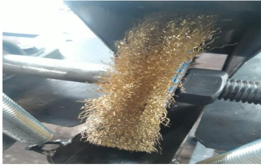
Gambar 4.17 Hasil Pemasangan Kawat Brush Ke Poros
