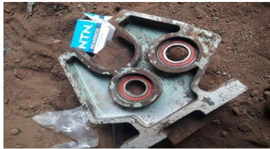
Gambar 4.11 Hasil Pemasangan Bearing Kekomponen Roll
