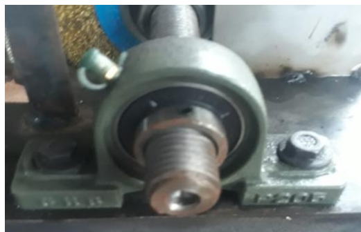
Gambar 4.16 Hasil Pemasangan Poros Dan Bantalan Bearing
