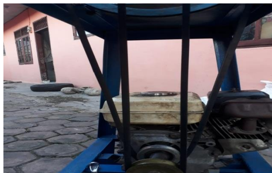
Gambar 4.25 Hasil Pemasangan Belt
