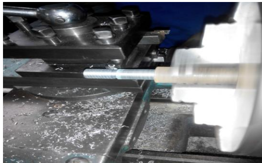
Gambar 4.15 Hasil Pembuatan Poros Pembersih
