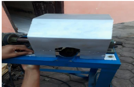
Gambar 4.21 Hasil Pemasangan Penutup Pembersih kulit
