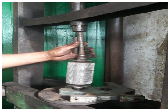
Gambar 4.13 Hasil Pemasangan Roll Peras Kebantalan
