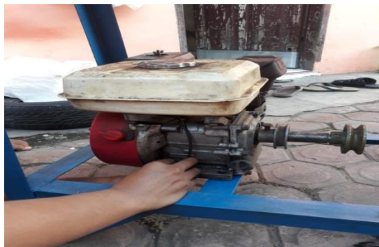
Gambar 4.22 Hasil Pemasangan Motor Bakar
