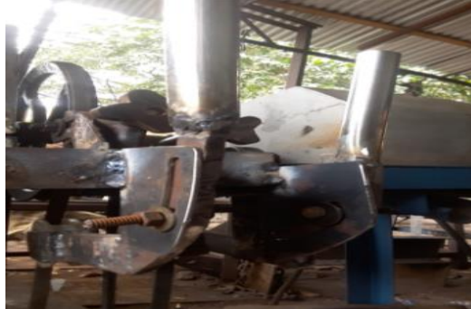
Gambar 4.5 Hasil Pembuatan Tuas Pemindah Daya
