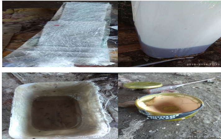
Gambar 3.1 Bahan Komposisi Blade Turbin Angin
