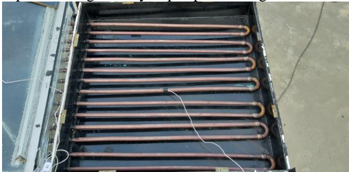
Pemasangan Thermocouple Pada Alat Desalinasi
