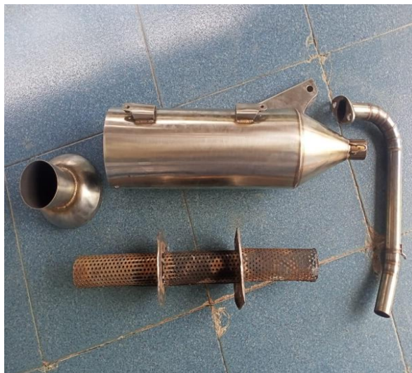
Gambar 4.10. Knalpot yang telah dimodifikasi
