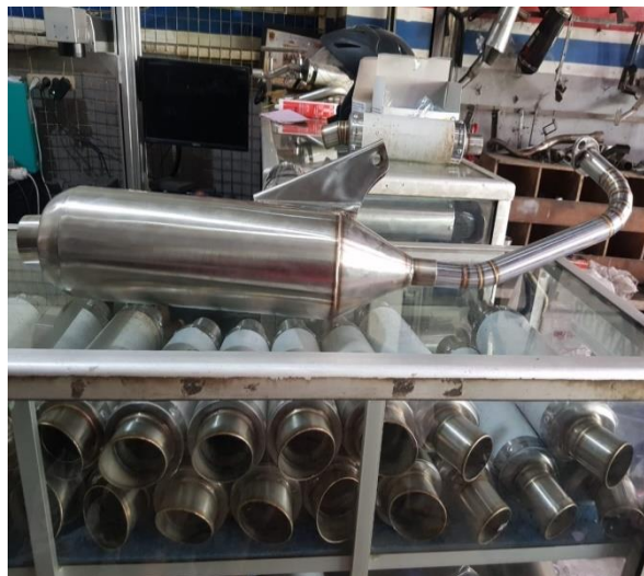
Gambar 4.8. Knalpot setelah dasatukan
