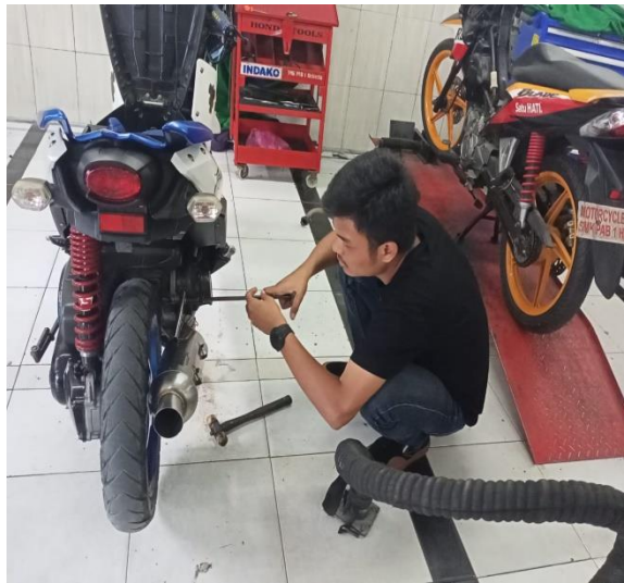
Gambar 4.13. Memasang knalpot pada sepeda motor
