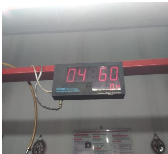
Gambar 4.15. Mengukur Rpm menggunakan Tachometer
