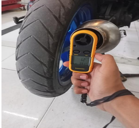
Gambar 4.16. Pengukuran kecepatan angin dan temperatur gas buang
