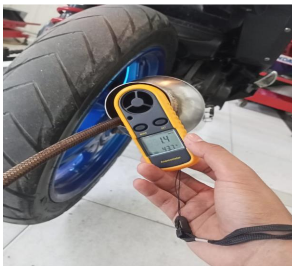
Gambar 4.17. Probe pada knalpot modifikasi
