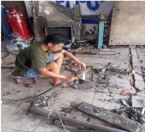
Gambar 4.5. Proses pengelasan knalpot
