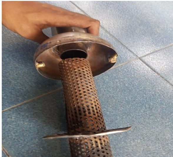
Gambar.4.11. Proses pemasangan saringan knalpot
