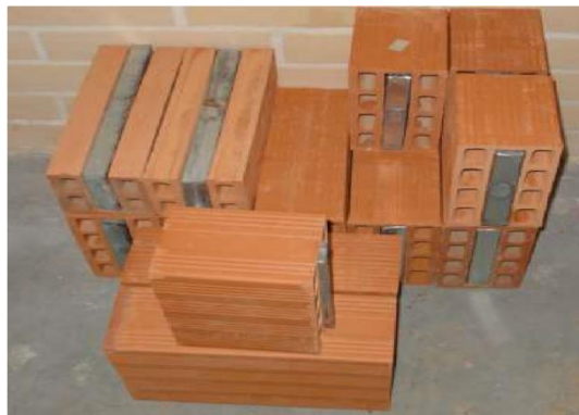
Gambar 2.6. Penggunaan PCM dengan metode enkapsulasi (Soares, 2012).
