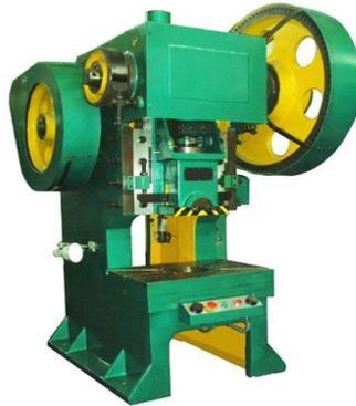
Gambar 2.3 Mesin *Punch* Mekanik
