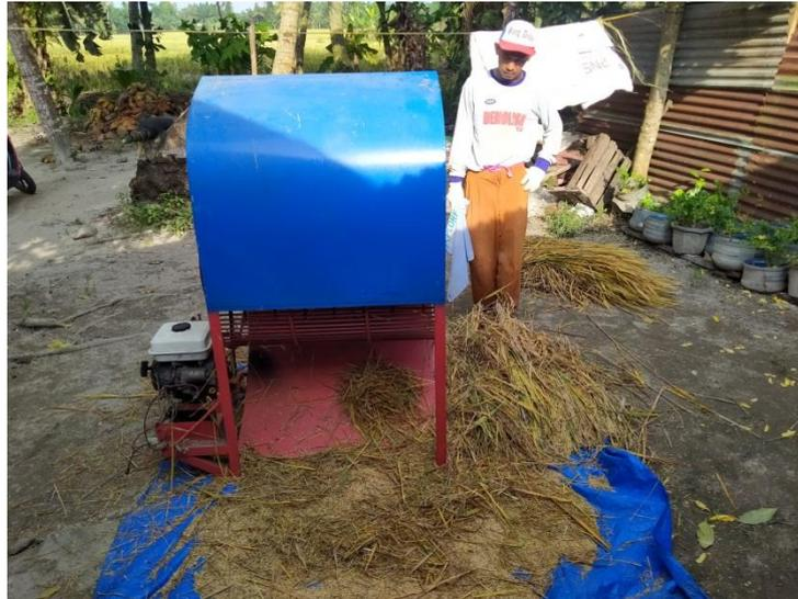
Gambar 4.9 Hasil Pengujian Mesin Perontok Padi
