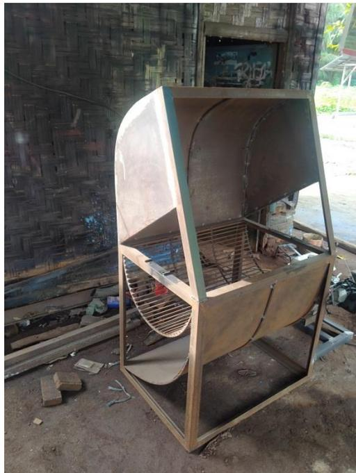
Gambar 4.4 Hasil Perancangan Rangka Mesin Perontok Padi
