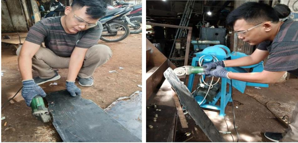
Gambar 4.3 Pemotongan plat baja
