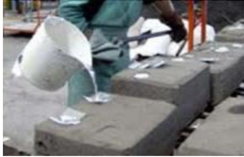
Gambar 2.1 Cetakan tidak permanen (*Expendable Mold*)
