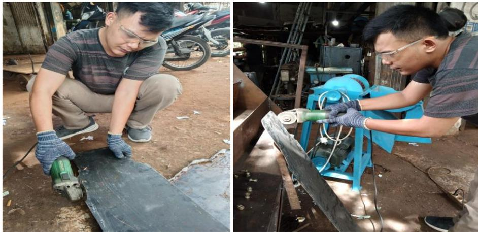
Gambar 3.15 Pemotongan plat baja
