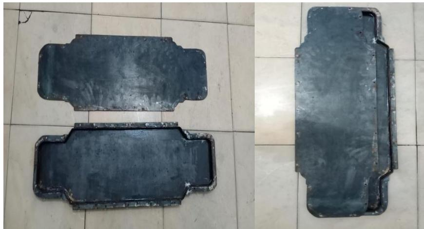
Gambar 3.20 Cetakan Papan Longboard
