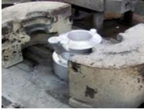
Gambar 2.2 Cetakan permanen (*Permanent Mold Casting*)
